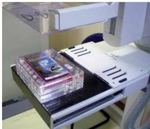
Foto 2. Tarjeta dosimétrica posicionada sobre el simulador radiográfico de mama.
